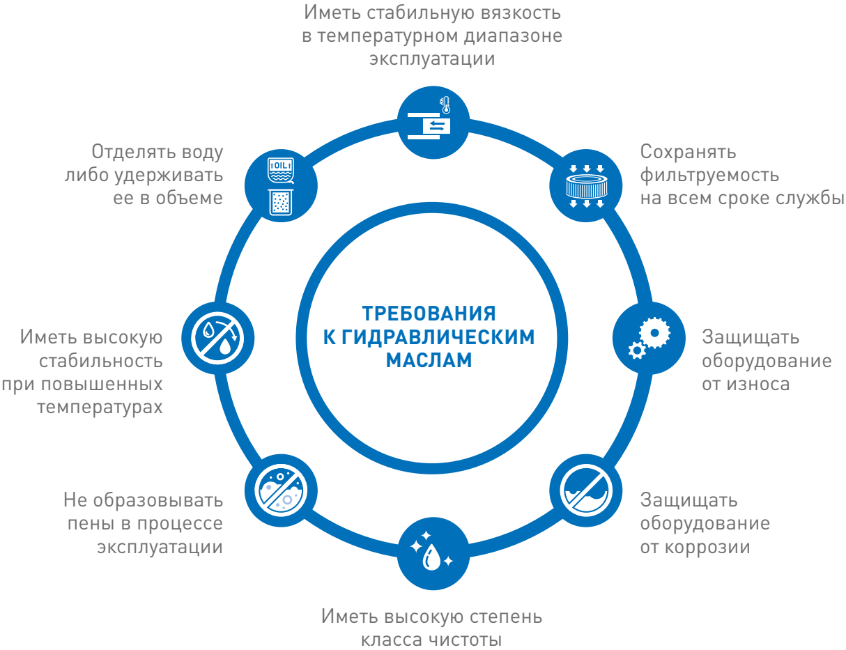
Гидравлическое масло является рабочим телом гидросистемы, во многом определяющим ее работоспособность, эффективность и срок службы.
